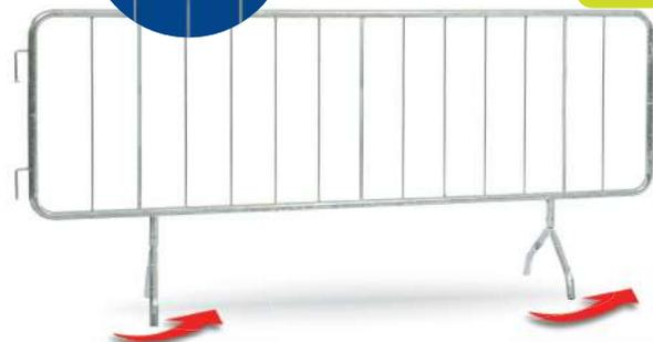
Transenna in acciaio zincato. Zincatura a caldo dopo la saldatura. Struttura in tubo di acciaio diametro 35 mm., sbarre verticali in tubo da diametro 16 mm. saldate alla distanza di 12 cm. Aggancio rapido con due ganci e due graffe laterali. Spazio orizzontalmente predisposto per l'inserimento di banda rifrangente in Classe 1 garantita e marcata 7 anni con pellicole bianco/rosso.
